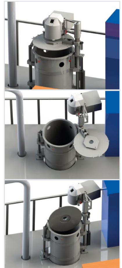
Einfacher Wechsel von Legierungen und Zerstäubersystemen für unterschiedliche Pulverkorn-Größen
