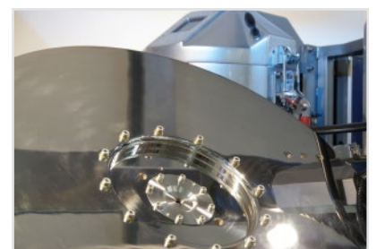
Polierte Edelstahloberflächen verhindern Pulveranhaftungen und sorgen für leichte und rückstandslose Reinigung.
